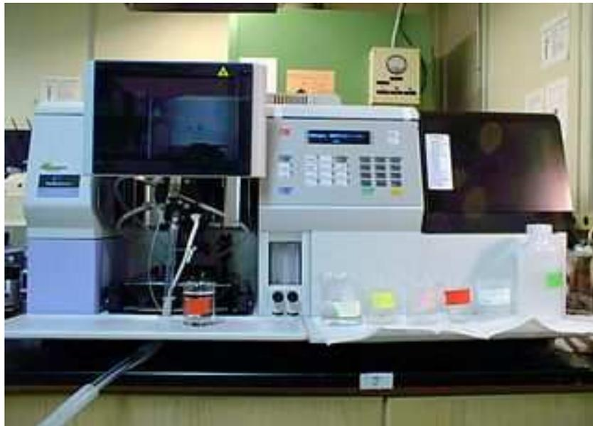
**Figura 6:** Foto do espectrofotômetro de absorção atômica: AAnalyst 100 da Perkin Elmer utilizado neste trabalho.
