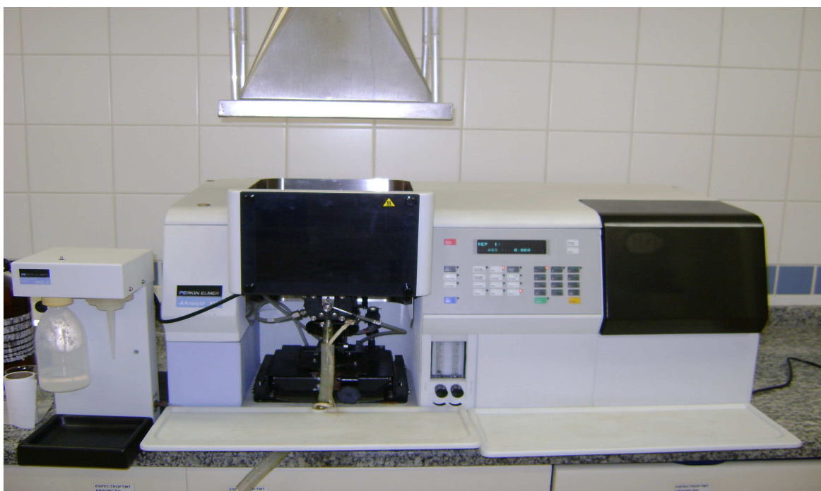
Figura 2: Foto ilustrativa do espectrômetro de absorção atômica, juntamente com o gerador de hidretos metálicos, utilizados neste trabalho.
