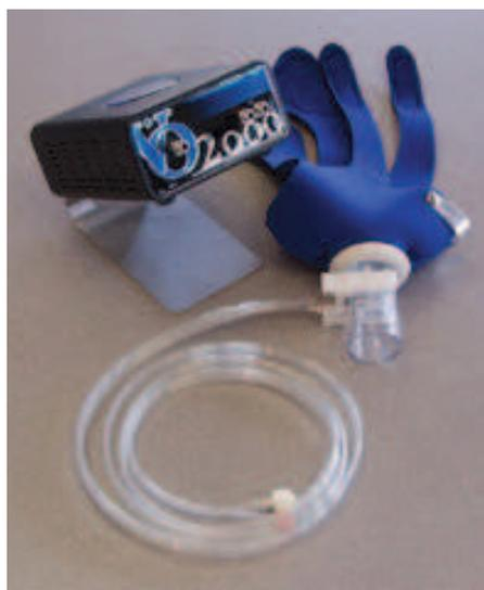
Figura 2 – Foto ilustrativa do equipamento pneumotacógrafo, que foi acoplado na máscara dos voluntários participantes deste trabalho para as medidas do  $VO_{2\text{máx}}$ .
