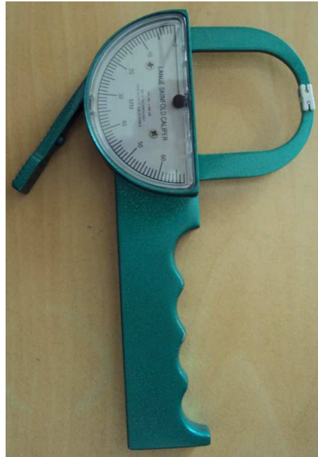
Figura 15 – Adipômetro Lange, instrumento para medição precisa do tecido adiposo subcutâneo.
