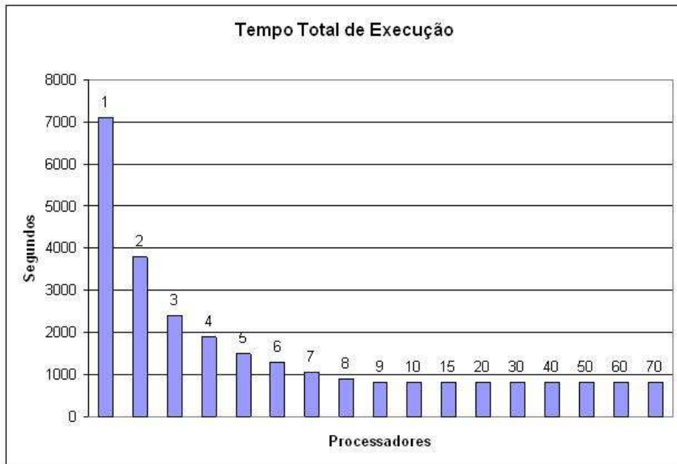
Figura 25: Simulação do tempo total de execução em uma plataforma homogênea
