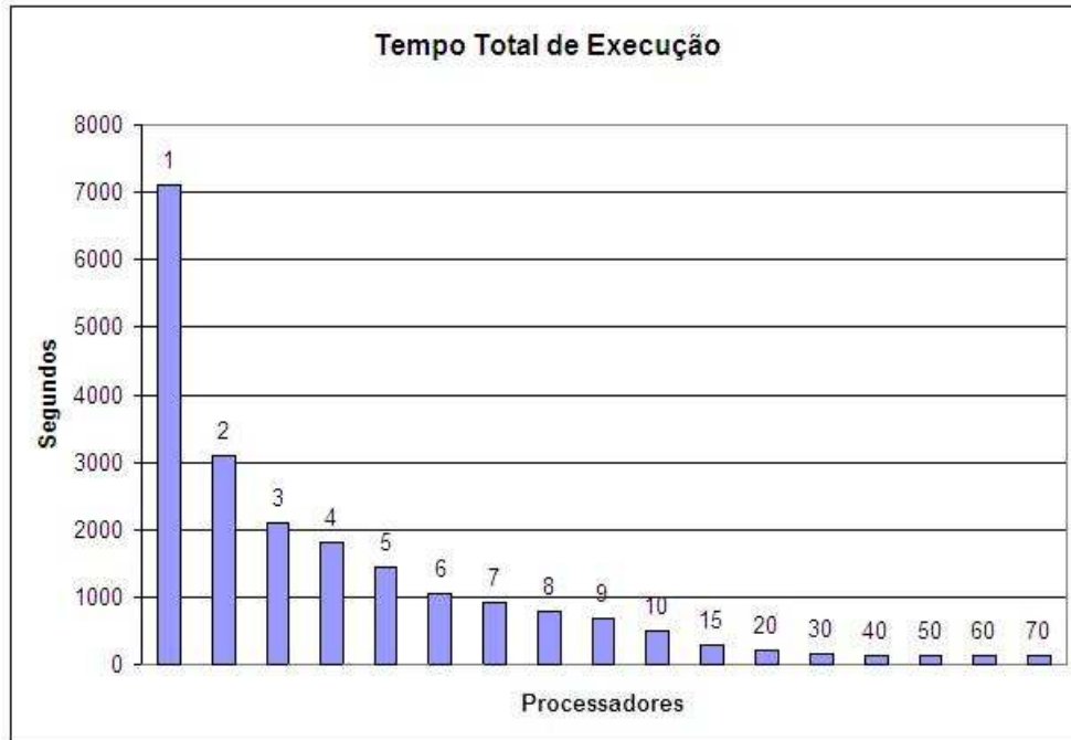
Figura 26: Simulação do tempo total de execução com agrupamento em uma plataforma homogênea
