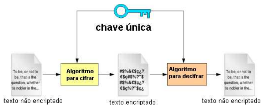
Figura 2.1: Conceito de criptografia simétrica, adaptado de Sotomayor (2005)
