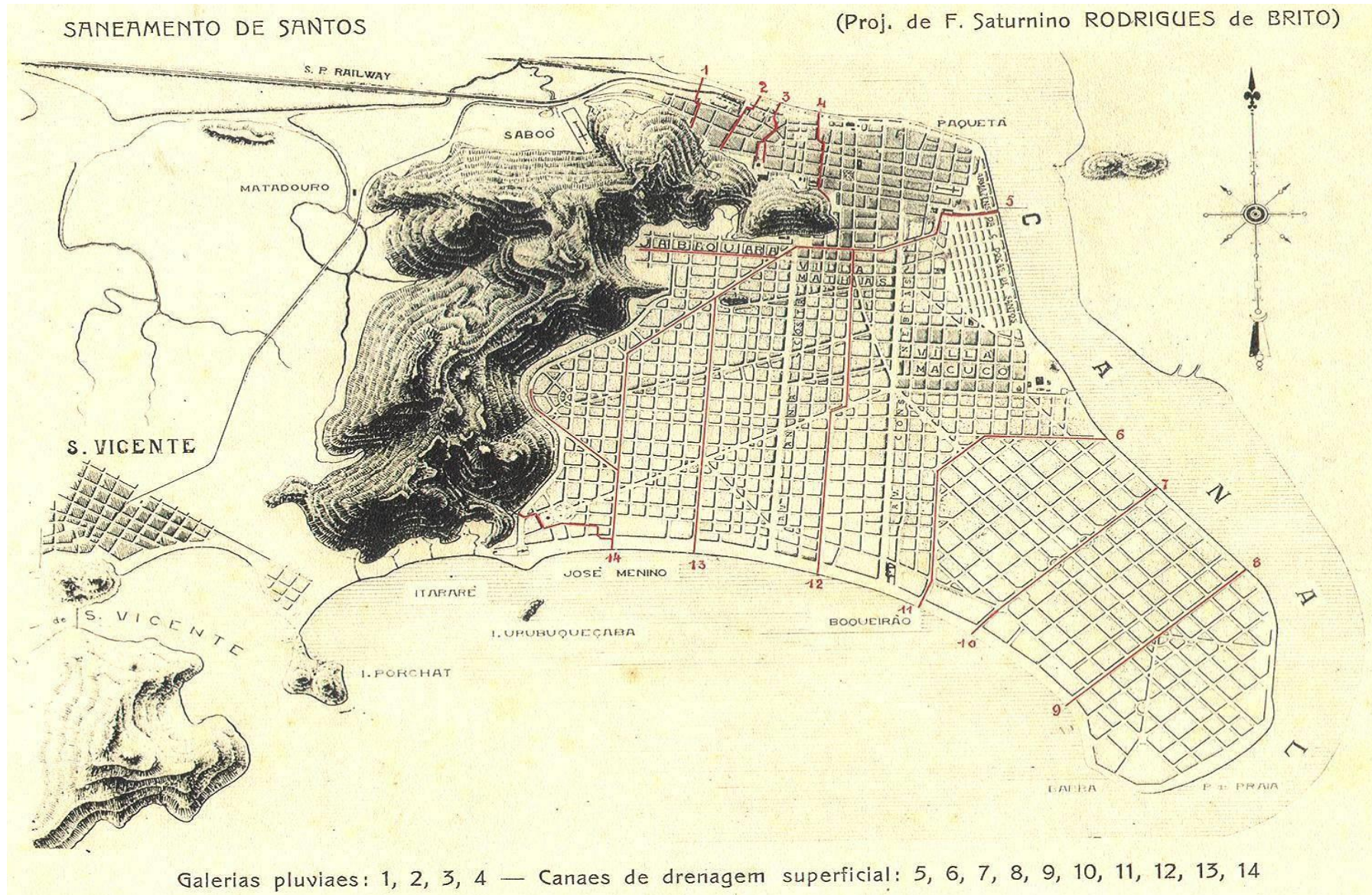
Figura 12-Projeto de Saturnino de Brito, obra dos Canais. Fonte: Álbum Comissão Saneamento de Santos, 1908
