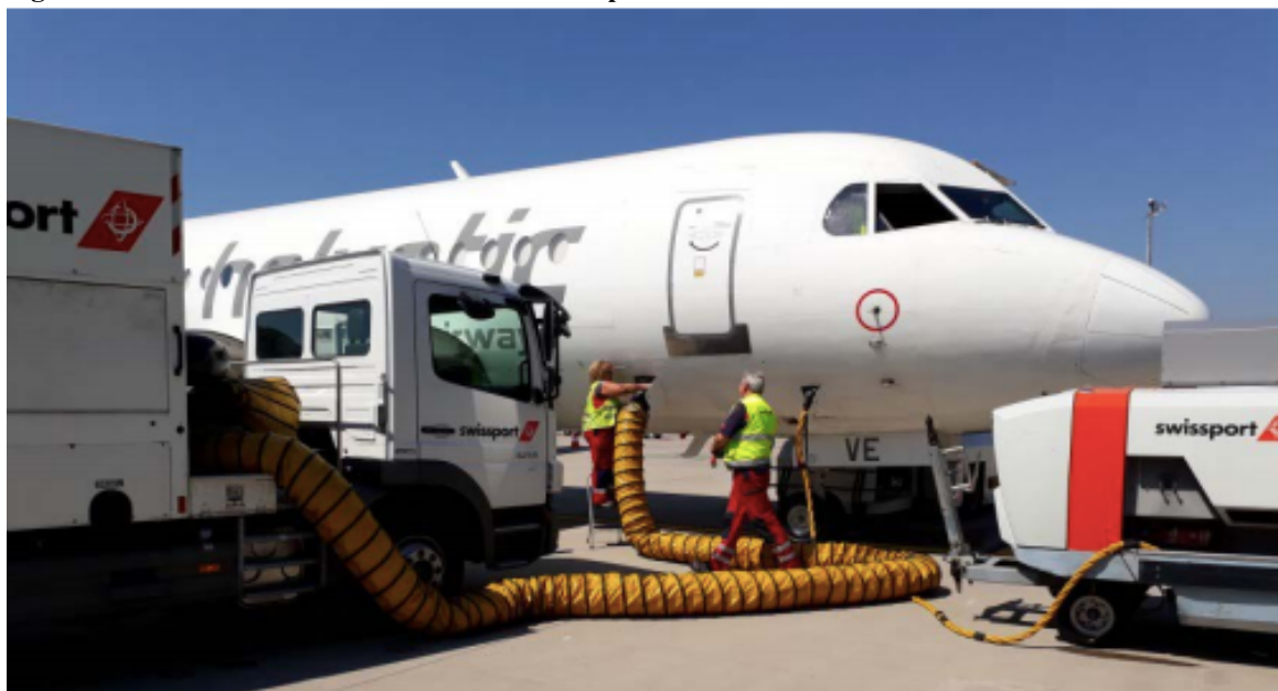
Figura 16 - Fonte de Ar-condicionado e Partida pneumática conectadas
