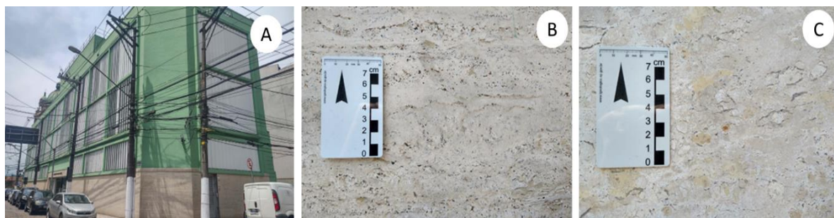
Figura 102 A, B e C – Litologias identificadas no elemento de geodiversidade Amor e Saúde (antigo prédio da Secretaria de Educação).
