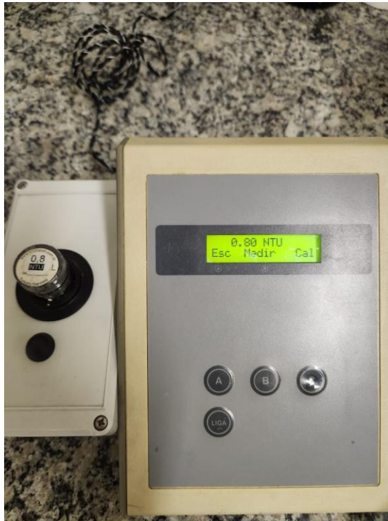
Figura 11 - Turbidímetro com série de padrões no momento da calibração
