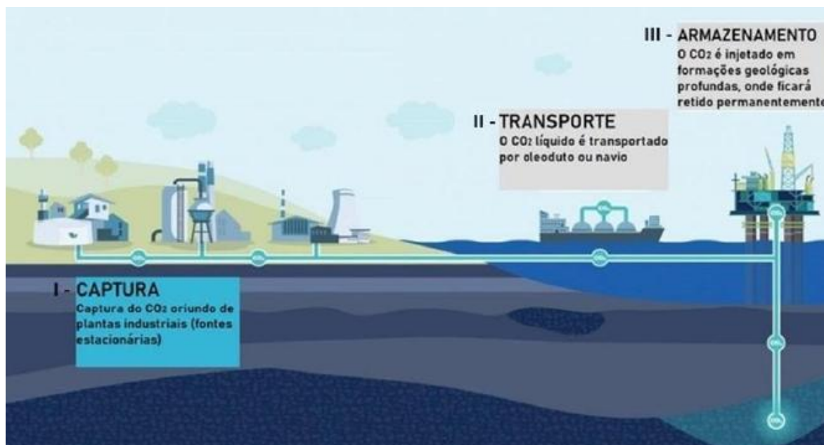
Figura 13 - Esquema ilustrativo da Cadeia de Captura e Armazenamento (CCS) de CO 2 contemplando as etapas de captura, transporte e armazenamento
