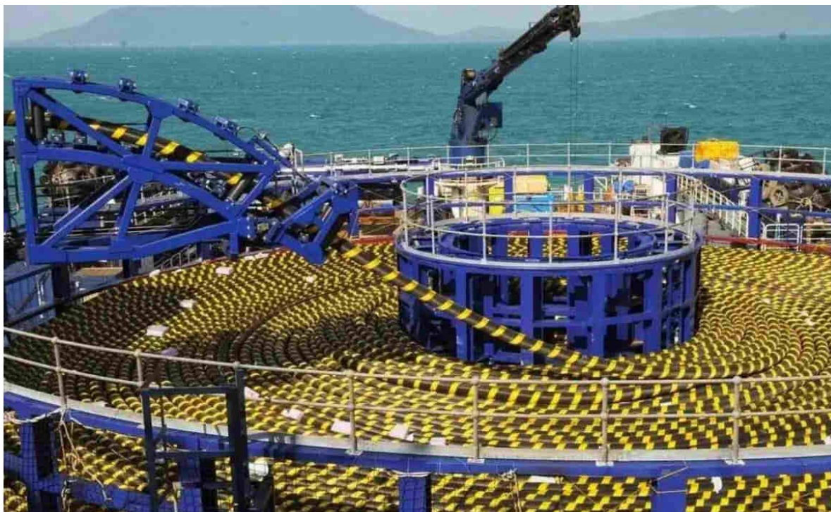
Fotografia 1 – Submersão do Cabo Elétrico Submarino no Mar Negro – Programa ESPIRE
