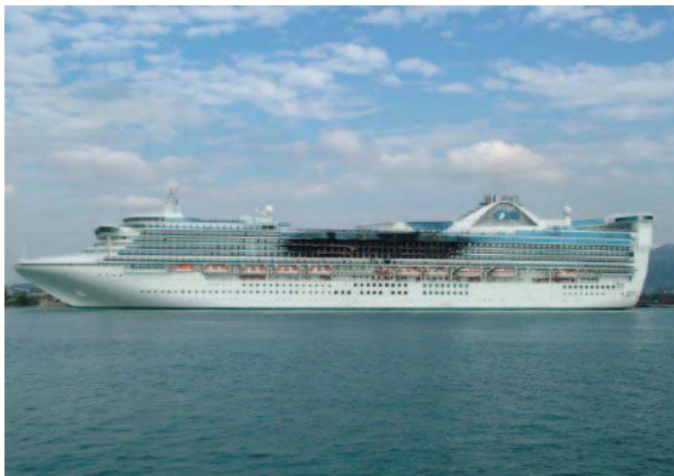
Figura 1 - Danos ocasionados por incêndio no Star Princess .
